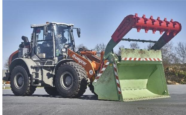
Der Rotor befindet sich in Arbeitsstellung, die hydraulische Schaufelrückwand schiebt den Schaufelinhalt lastabhängig gesteuert zum Rotor.
