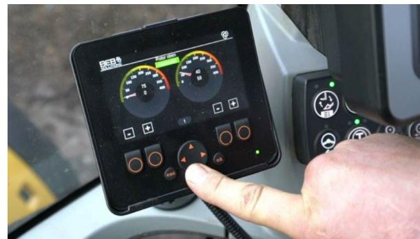
Die Materialaufnahme erfolgt wie bei einer herkömmlichen Schaufel. Gut durchmischte und lockere Materialabgabe bis zu 5 m Mietenhöhe, ohne dabei auf das aufbereitete Material zu fahren. Über das Keypad kann die Steuerung manuell oder automatisch erfolgen. Die Arbeitsabläufe können individuell den örtlichen Bedürfnissen angepasst werden.
