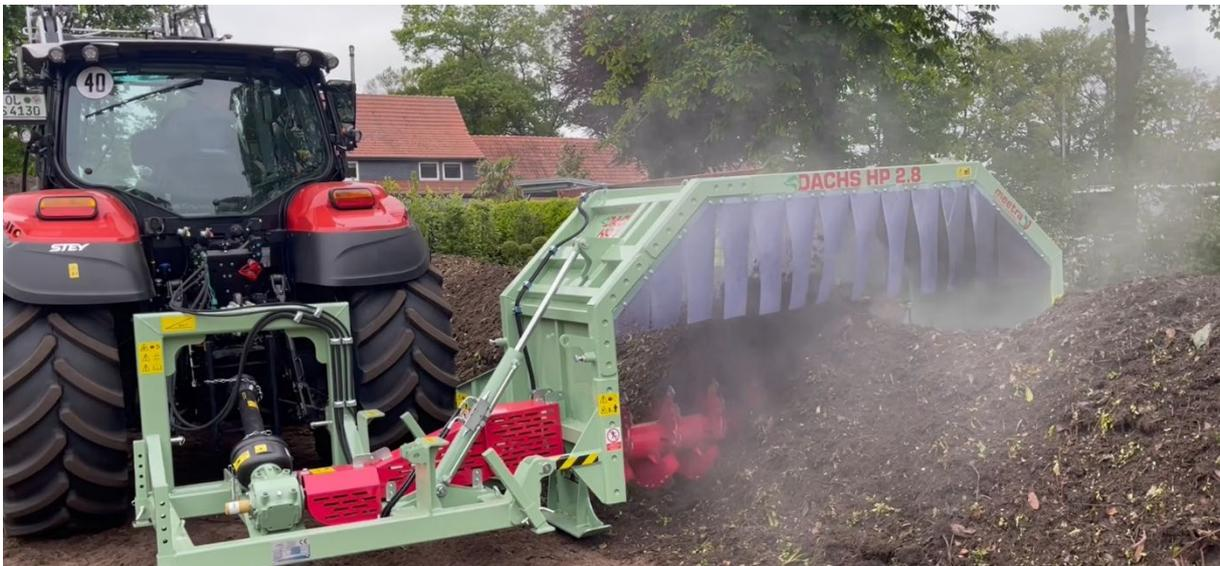
Der Kompostumsetzer HP ist für den Anbau an 3 Punktssystem (KAT II oder KAT III) für Traktoren mit einer Leistung von ca. 50-120 PS entwickelt. Angetrieben wird der Umsetzer mit der Traktorzapfwelle (540 Upm). Der Rotor dreht dann mit 180 Upm.
