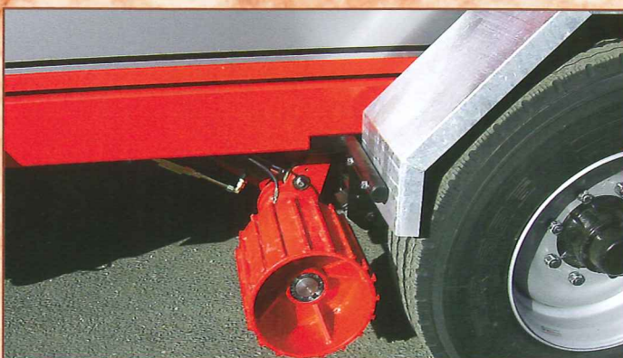
Hydraulischer Fahrtrieb Hydraulic Drive System Dispositivo idraulico marcia lentissima
